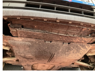
Motor, Alt muhafaza > Hasarlı
