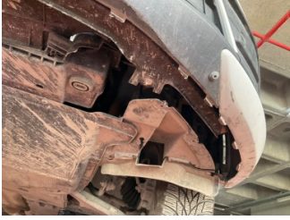
Motor, Alt muhafaza > Hasarlı
