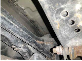
Kaporta, Sağ Arka Şase > Hasarlı
