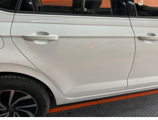
Kapı, sağ arka, Kapı, sağ arka > Çizik
