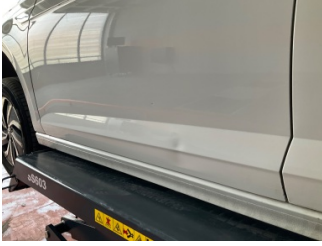
Kapı, sol ön, Kapı, sol ön > Ezik
